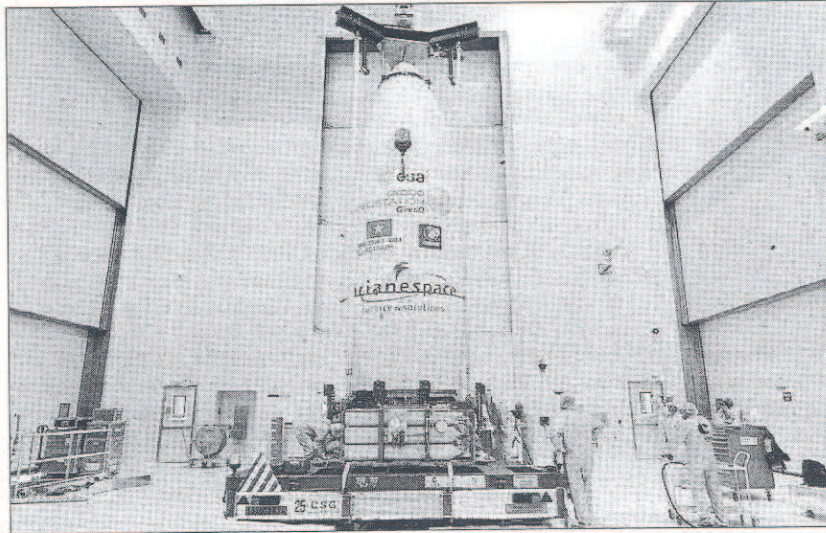
L'installazione del Payload Fairing eseguita dai tecnici della Siem
